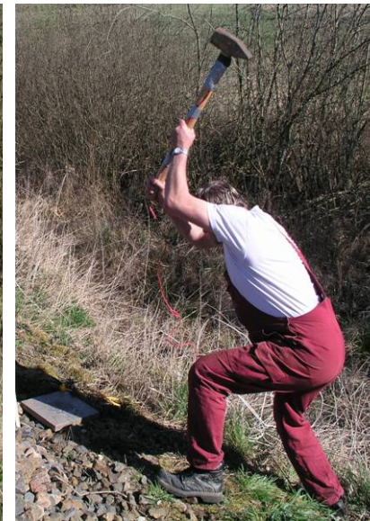
Beispiel Refraktions- seismik
